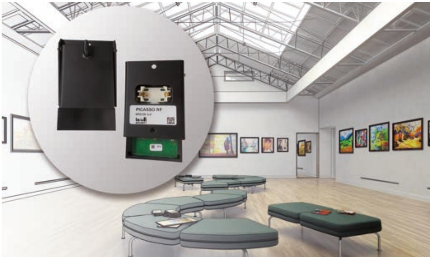
Il sensore PICASSO è un appendiquadro sensibile al tocco, movimento e/o rimozione dell'oggetto appeso che può essere collegato via radio a sistemi di sicurezza Visonic PowerG®. Il quadro da proteggere è appeso direttamente al sensore che ne valuta il peso. Minimi movimento o tentativi di rimozione o anche solamente il tocco sono valutati in relazione alla sensibilità impostata.
